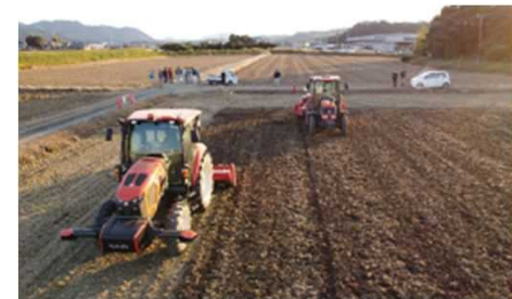
無人トラクター-有人トラクターの共同作業
