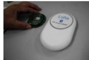
BLEとLPWAを中継する通信機器 (BLEルーター)
